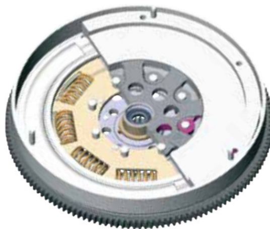
Стандартный DMF – плоский подшипник скольжения
