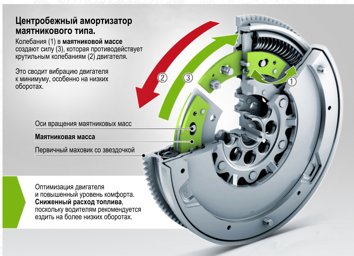
DMF с центробежным амортизатором маятникового типа
