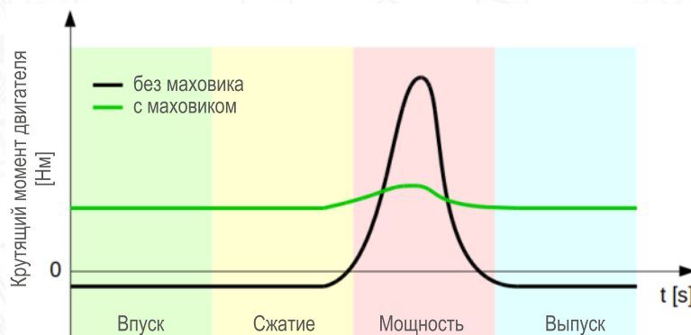
Крутящий момент двигателя во время 4-тактного цикла.
