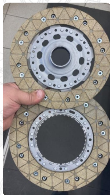
Фрикционные накладки из кевлара
