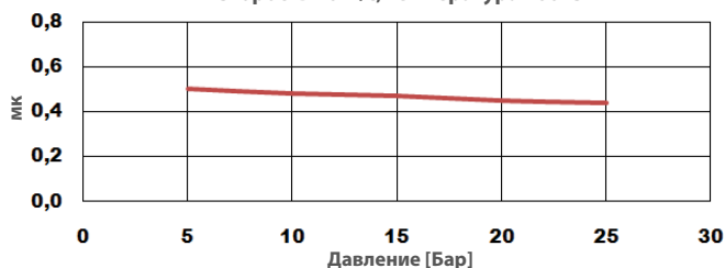
Коэффициент трения по сравнению с давлением Скорость 10 м/с; температура 100°C
