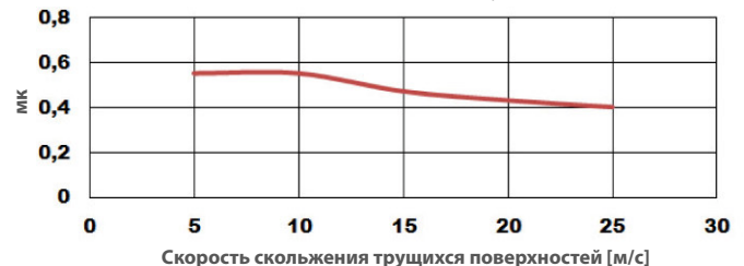
Коэффициент трения по сравнению со скоростью скольжения трущихся поверхностей Давление 10 бар; температура 100°C
