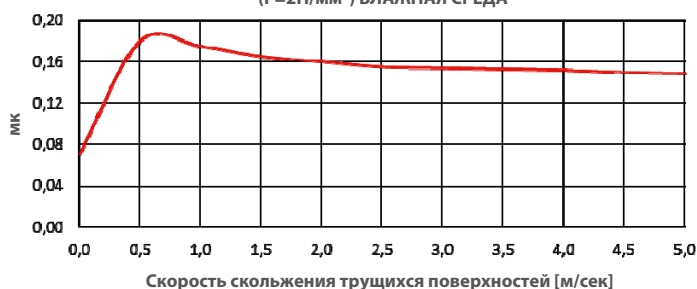
Скорость трения/скольжения трущихся поверхностей (P=2Н/мм 2 ) ВЛАЖНАЯ СРЕДА
