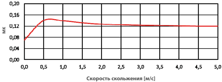
Коэффициент трения/скорость скольжения ( p=0,55 \text{ Н/мм}^2 ) во влажном состоянии
