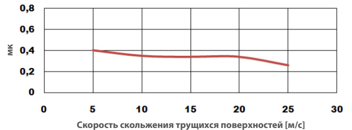
Коэффициент трения по сравнению со скоростью скольжения трущихся поверхностей Давление 10 бар; температура 100°C
