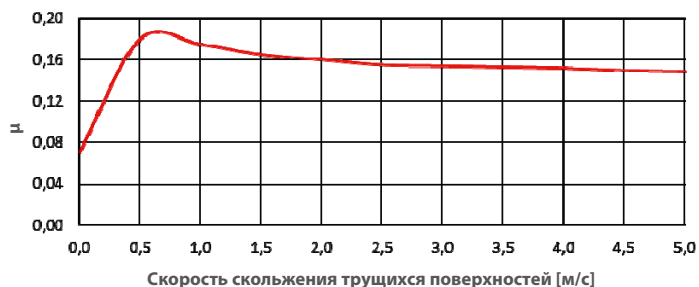
Скорость трения/скольжения трущихся поверхностей ( p=0,55 \text{ Н/мм}^2 ) во влажном состоянии
